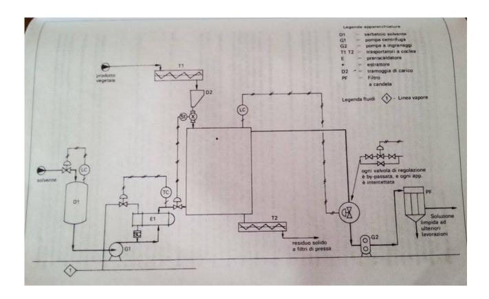
In Fig. 2 viene mostrato uno schema dettagliato di un estrattore con i rispettivi controlli.
