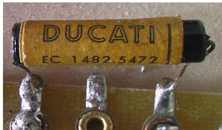
Condensatore da 2000pF per la rivelazione
